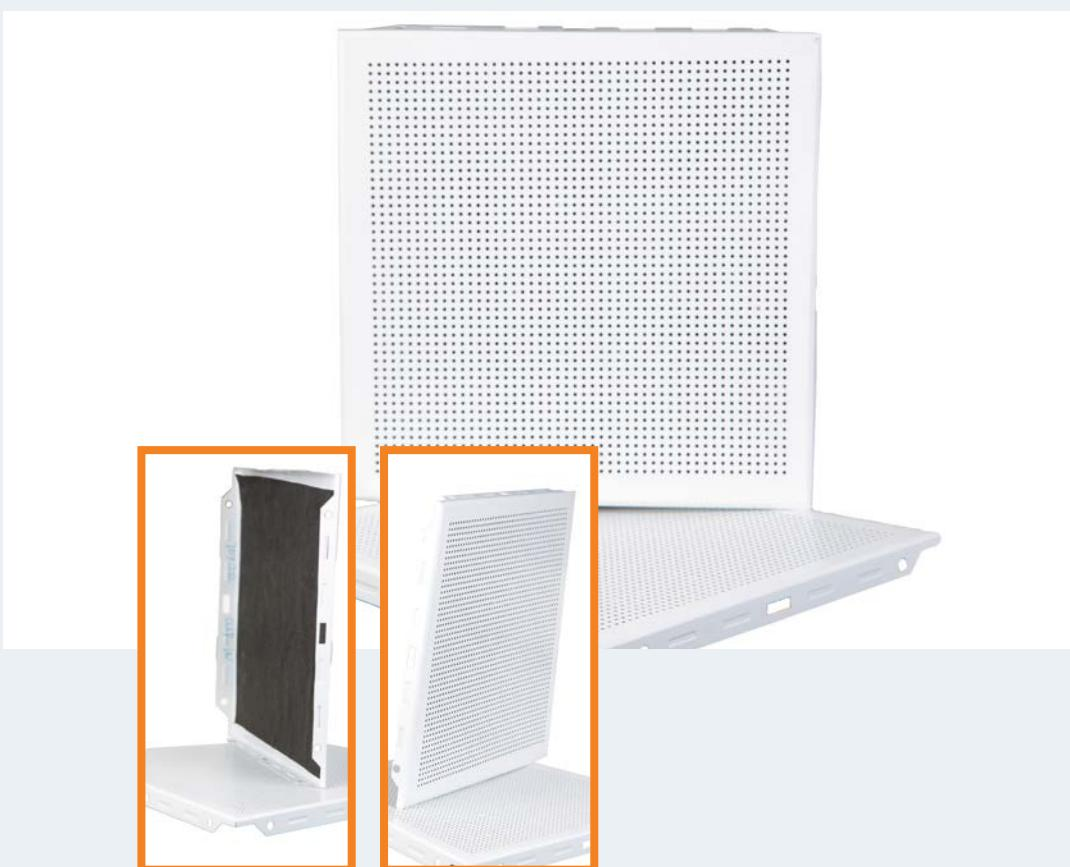
Alüminyum rulo levhaların TS EN 13964 standartına uygun olarak delme, kesme, bükme işlemlerinden sonra elektrostatik toz boyası (polyester esaslı) ile boyama yapılarak oluşturulan tavan panelleridir. Bu panellerinin tavana tutturulması için özel taşıyıcı sistemleri kullanılmaktadır.
