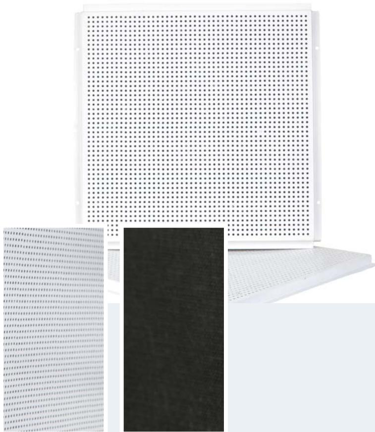
Sarkmali (lay-in) Sistem, T15, T24, T24 kanallı ve Ultraline kanallı taşıyıcılara, alüminyum ya da galvaniz plakaların üstten serbest bırakılması ile oluşturulur. Taşıyıcılar panellerin arasında kalır ve bu şekilde yarı gizli ve gölgeli bir görünüm elde edilir. Tüm paneller birbirinden bağımsız olarak hiçbir apparata gereksinim duymadan el ile sökülebilir. Böylece mevcut tesisata kolay ve hızlı erişim imkanı sağlanır.
